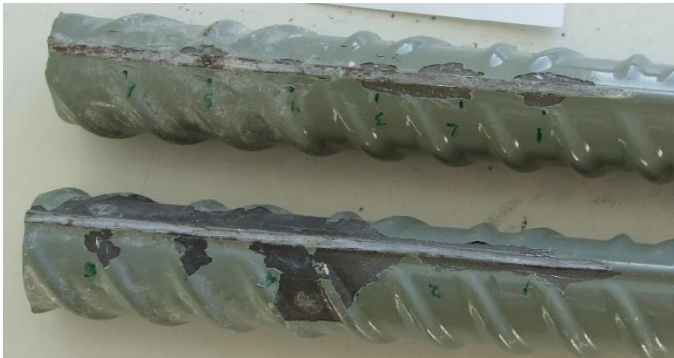
Figur 10. Epoxibeläggning med dålig vidhäftning vid blottlagd yta.
