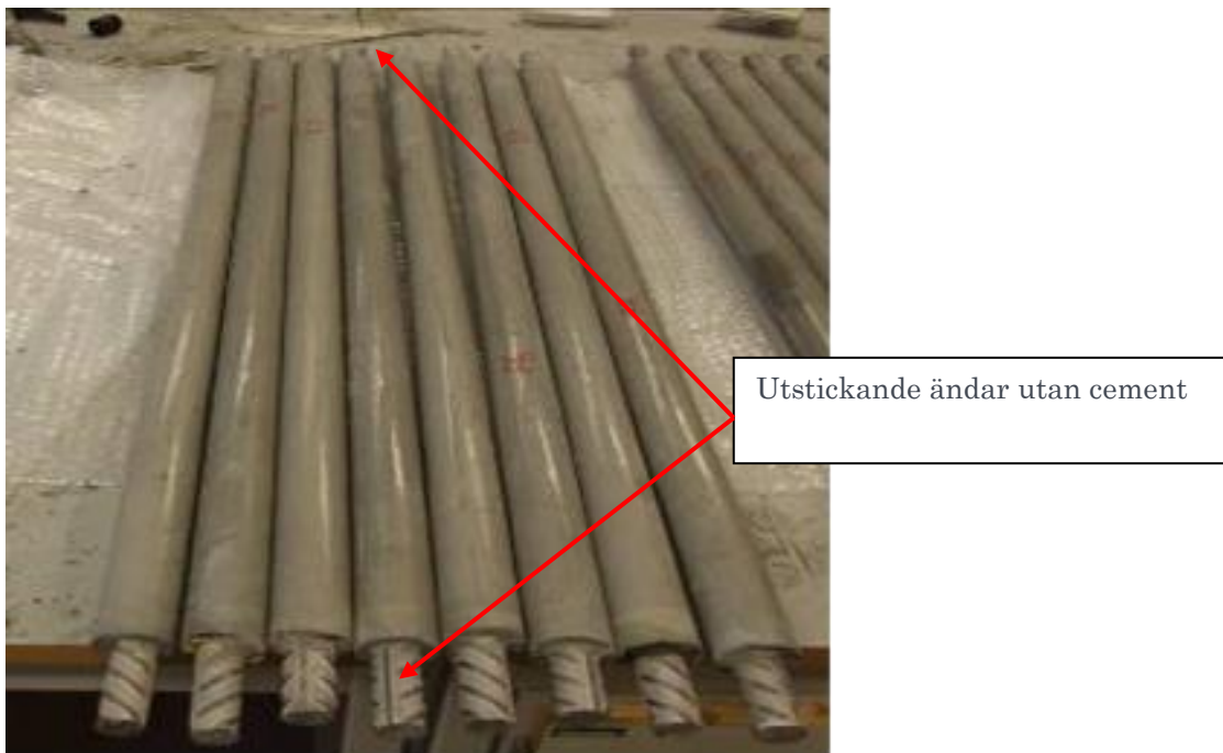
Figur 3. Provkroppar för korrosionsprovning i tunnlar.
